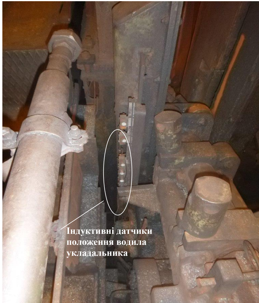
Рис. 4.14. Індуктивні датчики положення водила укладальника
