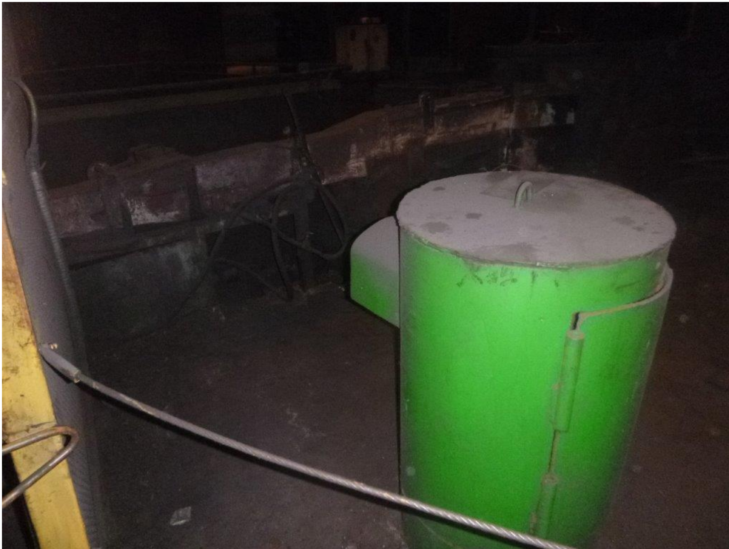
Рис. 4.13. Установка фотооптического датчика прогину перед трайбапаратом (мех.41)
