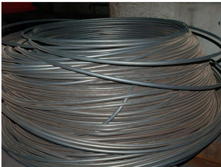
Рис. 1.4. Фотографія мотка, у якого при змотуванні відбувся зрив верхніх витків
