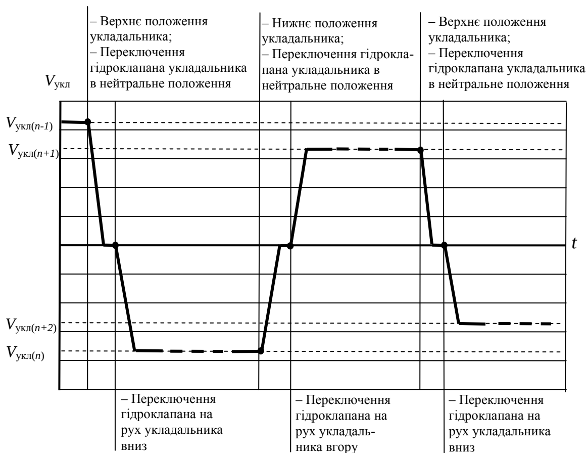
Рис. 2.10. Графік швидкості переміщення укладальника в процесі змотування мотка при постійному міжвитковому кроці и швидкості прокатки
